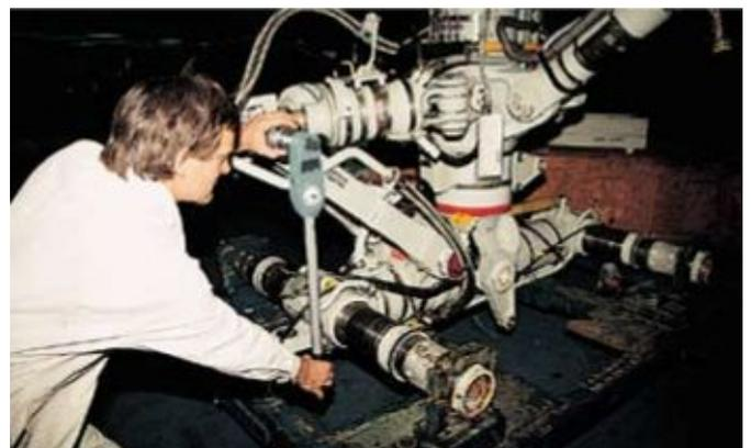
**концевые насадки для ключей динамометрических**
