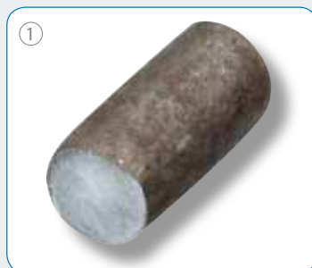
Вырезаются из заготовки хромованадиевой стали 31CrV3
