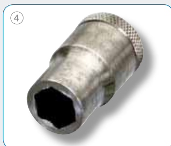
Нататка по внешнему диаметру. На этом и следующем этапе ГЕДОРЕ использует высокотехнологичное оборудование, созданное в собственном машиностроительном бюро
