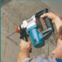
Компактный и вместе с тем прочный и надежный. Для замены бура просто вставьте его в патрон или выньте из патрона, одним движением. Расцепляющая муфта предотвращает рывок при заклинивании бура.
