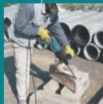
Мощный 2 кг перфоратор имеет D-образную рукоятку эргономичной линейной конструкции, для удобства использования. Три режима работы: сверление, сверление с ударом или долбление. Установка долота в 40 положениях без дополнительных принадлежностей. Регулируемая скорость вращения + реверс.
