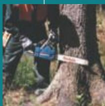
Сверхнадежный мотор для максимальной производительности при особо тяжелых режимах работы. Литой цилиндр с охлаждением. Инжекторный карбюратор. Двойная система очистки воздуха. Инерционный тормоз цепи. Наружное электронное зажигание.
