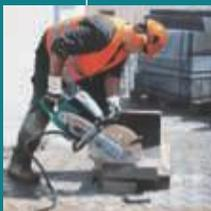
Система "двух масс" для снижения вибрации. 5-уровневая система фильтрации для работы в условиях сильной запыленности. Магниевого кожух, изготовленный методом литья под давлением. Карбюратор: с диафрагмой, стартер: механический.
