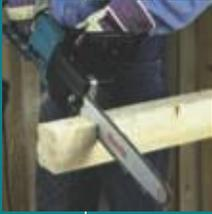
Продольно установленный мощный мотор (2000 Вт). Пила отлично сбалансирована и удобна в обращении. Автоматическая смазка цепи. Дополнительный электрический тормоз останавливает цепь при отключении питания.
