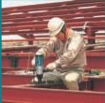
Высокий крутящий момент - 588 Нм (6000 кгс/см) для сверхтяжелых условий работы. Удобный курковый включатель с реверсом облегчает работу одной рукой. Имеет поворачиваемую на 360° рукоятку, устанавливаемую под любым углом для облегчения работы в любом положении. Доступ к угольным щеткам извне облегчает техническое обслуживание.
