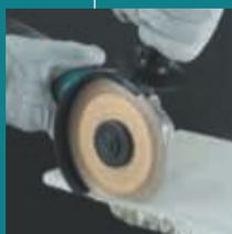
Высокоэффективный двигатель с достаточной мощностью и высокой стойкостью к перегреву. Лабиринтная конструкция защищает все шарикоподшипники от пыли и строительного мусора. Маленький диаметр корпуса для удобства работы. Замок шпинделя для легкой замены диска. Чемодан для переноски в комплекте.
