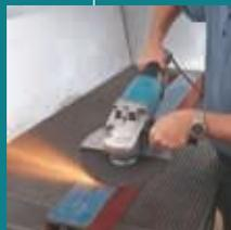
Надежный и пылезащитный 2000 Вт мотор. Идеальна для отрезных работ по металлу. Лабиринтное уплотнение защищает мотор и подшипники от загрязнения. 9069F/9069SF: опорная шайба "Суперфланец" облегчает демонтаж диска после работы.
