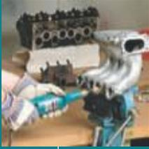
Небольшой вес для полного контроля над процессом шлифования. Идеальна для легкого и точного шлифования. Шлифовальная машина размером с ладонь имеет широкую сферу применения. Высокая скорость (25 000 об/мин) для максимальной производительности.
