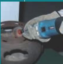
Высокоскоростная прямая шлифовальная машина с максимальным размером патрона 8 мм. Специальная система привода с муфтой (Super Joint System ®) от Makita предотвращает рывки инструмента при работе и пуске. Лабиринтное уплотнение защищает мотор и подшипники от загрязнения. Идеальна для обработки внутренних поверхностей, удаления краски и т.п. с помощью шлифовальных листовых щеток.
