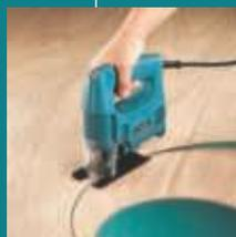
Облегченная модель с низким уровнем вибрации и шума. Электронная регулировка скорости. Распилка под углом до 45° в обе стороны, фиксаторы угла 45° и 90°. Электронная регулировка скорости и 3-х ступенчатый маятниковый ход.
