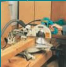
Чистота и аккуратность реза этой пилы устанавливает профессиональный стандарт для торцевой, угловой и наклонной распиловки. Двойные направляющие на линейных шариковых опорах. Электронная система поддерживает постоянную скорость распиловки под нагрузкой. Большие размеры стола и поворотная линейка обеспечивают удобную поддержку заготовки. Косой рез в обе стороны. LS1013F – флуоресцентная лампа на гибкой ножке.
