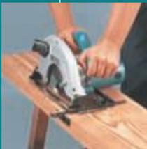
Низкий уровень шума и вибрации для повышения комфорта при работе. Облегченная конструкция пилы с редуктором полностью на основе шариковых подшипников увеличивает срок службы инструмента. Расклинивающий нож для предотвращения заклинивания диска во время работы.
