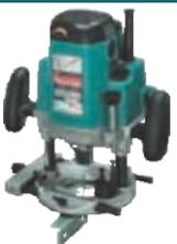
Потребляемая мощность при непрерывной работе 1850 Вт
