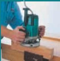
Высокопроизводительный профессиональный фрезер с мощным 1650 Вт мотором. Выбор глубины обработки 0-60 мм обеспечивает легкое проникновение вглубь заготовки или сквозь нее.
