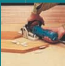
Для прочных щитовых соединений. 6 установок глубины для шпонок #0, #10, #20. Прецизионный реечный механизм для настройки вертикальной рейки. Литая алюминиевая поворотная линейка с фиксаторами на 45° и 90°. Расшивка паза до 12 мм.
