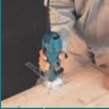
Эргономично удлиненный узкий корпус обеспечивает удобный захват и снижает утомляемость оператора. Резиновый ролик для легкой и точной настройки глубины фрезерования.
