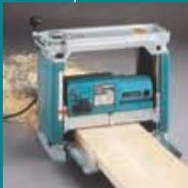
Компактность и легкость (27 кг) облегчают транспортировку. Уникальный механизм подачи обеспечивает гладкую чистовую обработку с минимальной потерей материала. 4-х опорная конструкция и диагональная крестовина обеспечивают качество обработки.
